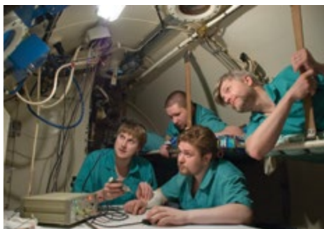
10-суточный гипербарический эксперимент по испытанию пожаробезопасной гипоксической кислородно-азотно-аргоновой среды
